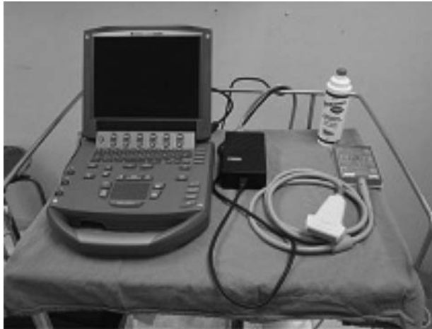
Figura 9-4. Ultrasonido con un transductor de alta frecuencia (13 MHz).
